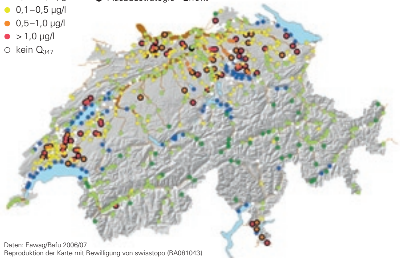
Abb. 2: Modelliertes Carbamazepin-Risikopotenzial bei Niederwasser Q_{347} . Schwarz umrandet sind Abwasserreinigungsanlagen, die ausgebaut werden müssten, damit die Carbamazepin-Konzentrationen (inkl. Metaboliten) in den Oberflächengewässern nirgends über 0,5 \mu\text{g/l} steigen.
