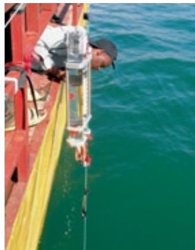
Sedimentfallen fangen absinkende Algen auf – einer der Faktoren im Nährstoffkreislauf des Sees.
