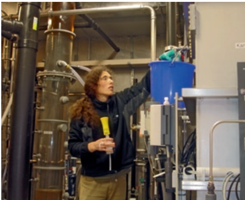
Beprobung des Ozonreaktors in der Wave21-Pilotanlage beim Seewasserwerk Lengg der Stadt zürcher Wasserversorgung.
