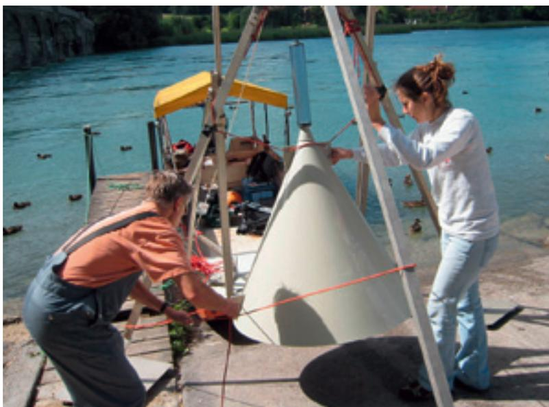
Mit trichterförmigen Gasfallen fangen Forschende das Methan auf, das vom Grund des Wohlensees an die Seeoberfläche aufsteigt.
