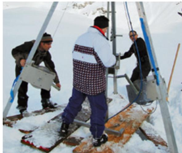
Damit die Geräte zur Entnahme der Bohrkern stabil stehen, findet die Sedimentbohrung auf dem gefrorenen Steinsee statt.
