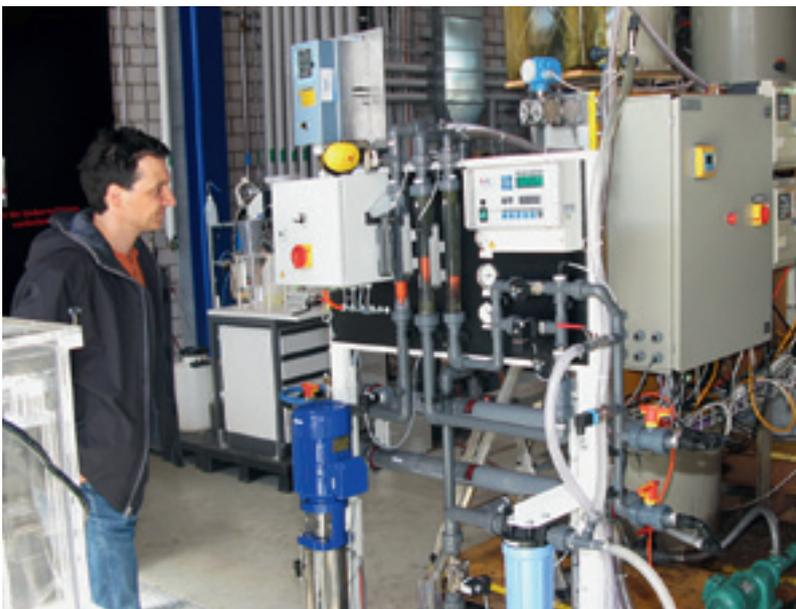
Anammox-Testanlage in der Versuchshalle der Eawag.
