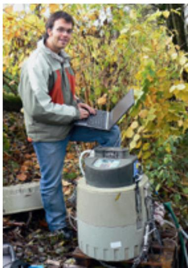
Ein Mitarbeiter überwacht die automatische Probenahme an der Petite Glâne im Einzugsgebiet des Murtensees.
