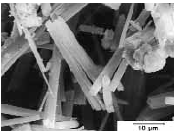
Abbildung: Elektronenmikroskopische Aufnahmen von Kalkkristallen an der Rohrwand einer Trinkwasserversorgung.
