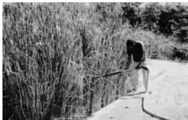
Abbildung 2: Schlammbeschickung der mit gesunden Pflanzen bewachsenen Pilotanlage. (Foto: Thammarat Kootatep, Bangkok)
