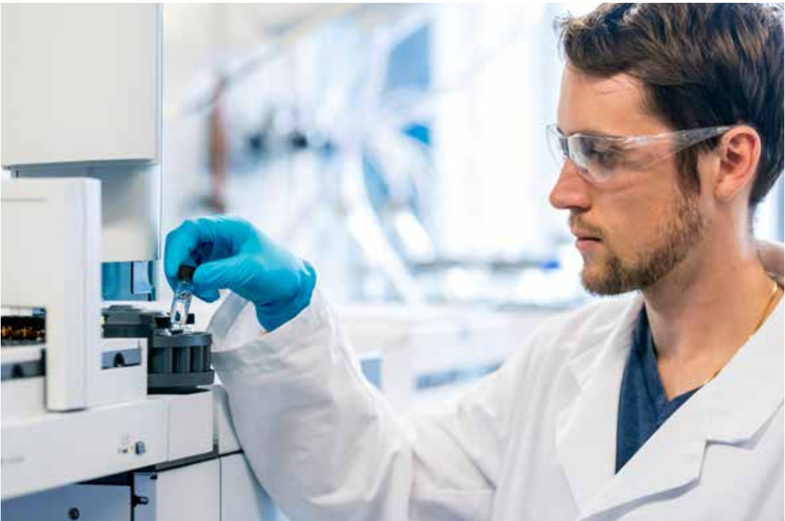
Selektive und nachweisstarke Analyse der Pyrethroidinsektizide mittels Tandem-Massenspektrometrie gekoppelt an die Gaschromatographie. Im Bild der wissenschaftliche Mitarbeiter Michael Patrick.
