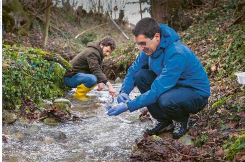
Durch Extrahieren und Sequenzieren der eDNA aus Wasserproben kann die Biodiversität bestimmt werden.
