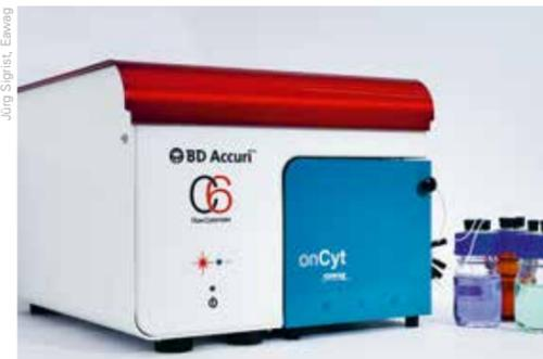
Système connecté et entièrement automatisé de cytométrie en flux constitué d'un cytomètre en flux traditionnel (en rouge et blanc) et d'un module d'automatisation développé par l'Eawag (en bleu).
