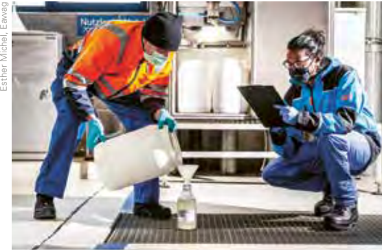
Une partie d'un échantillon composite d'eau usée est prélevée à la station d'épuration pour être analysée au laboratoire.
