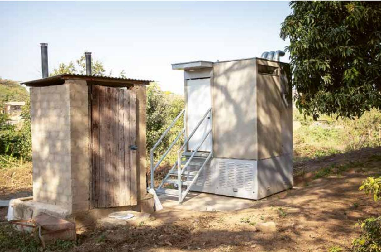
**Photo** Le cabanon des toilettes Blue Diversion Autarky (à droite) installé pour l'essai de terrain à côté des toilettes sèches dans un jardin de Durban.
