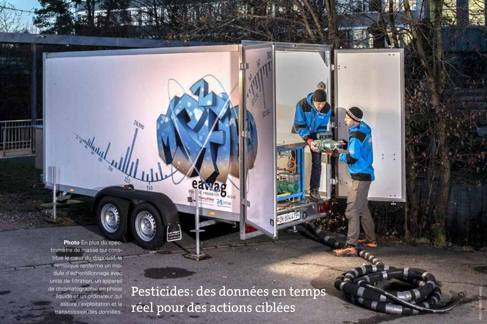
**Photo** En plus du spectromètre de masse qui constitue le cœur du dispositif, la remorque renferme un module d'échantillonnage avec unité de filtration, un appareil de chromatographie en phase liquide et un ordinateur qui assure l'exploitation et la transmission des données.
