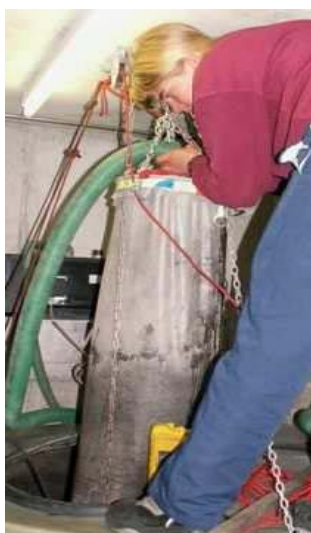
Abbildung 6 Entwässerungssack mit Aufhängevorrichtung zum Abtropfen über dem GR
