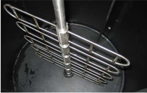
Abb. 5: Adsorptionsreaktor mit Rührwerk und Statoren.
