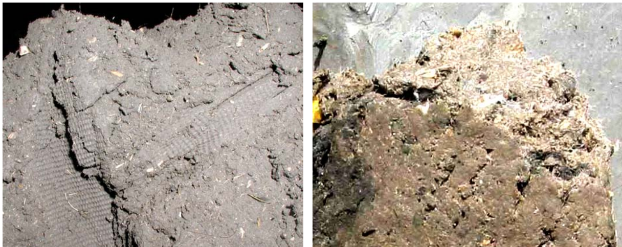
Figur 20: Klärschlammaggregate von entwässerten Faul- und Rohschlamm (rechts). Beim FS sind gut Abdrücke der Drainageelemente zu erkennen
