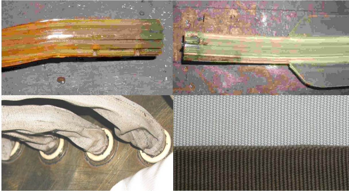
Figur 26: Rundkern bzw. Laschenkern der verwendeten Drainageelemente (obere Reihe); (untere Reihe, linkes Bild) montierte Filterelemente (Laschenkern + Textil V1); (rechtes Bild) neues und gebrauchtes Textil (Filter V1)
