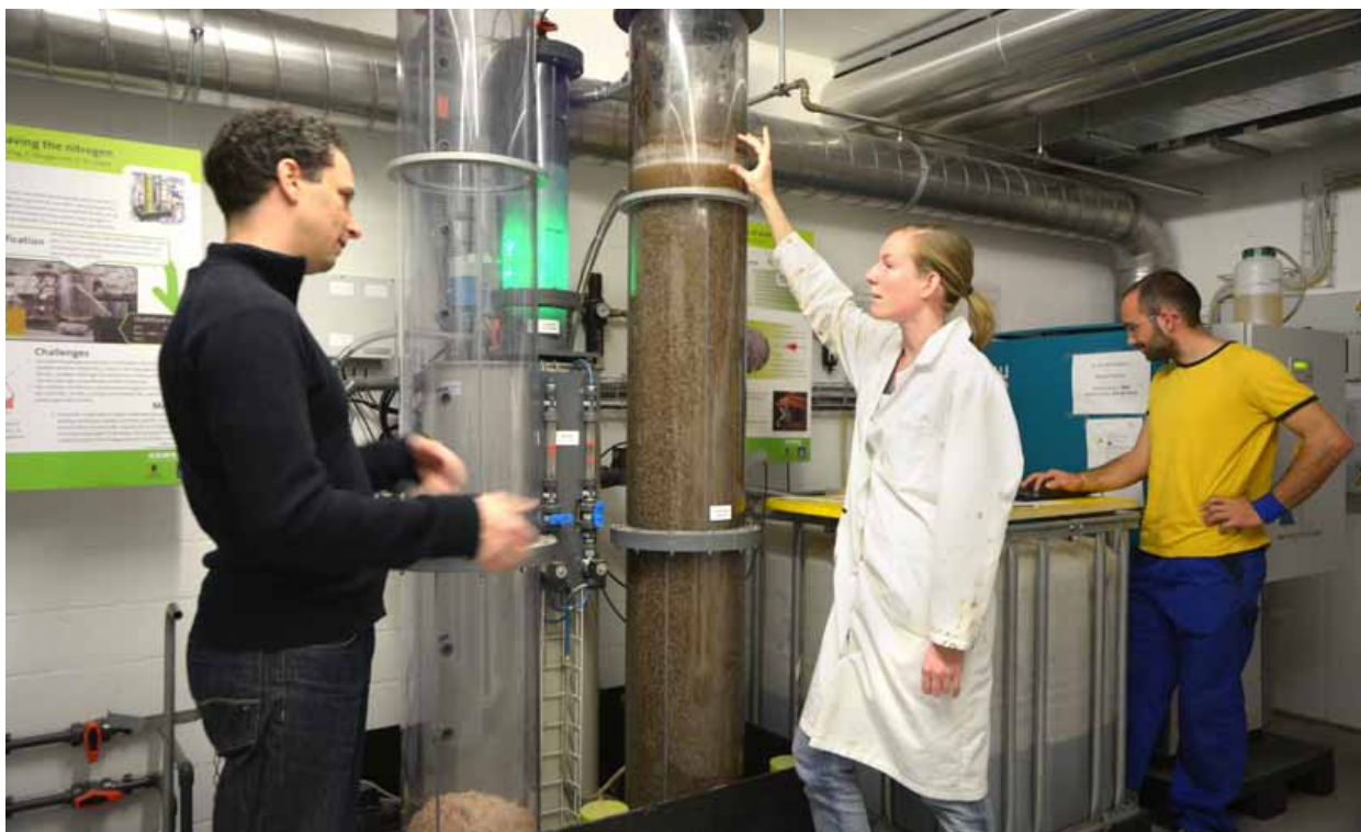
Abb. 1: In der Pilotanlage an der Eawag in Dübendorf wird der Urin der Mitarbeitenden zu Dünger aufbereitet.
