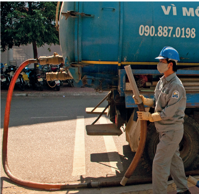
Figura 4.12 Ejemplo de un buen método para ensamblar la manguera fácil y rápidamente (foto: Linda Strande).
