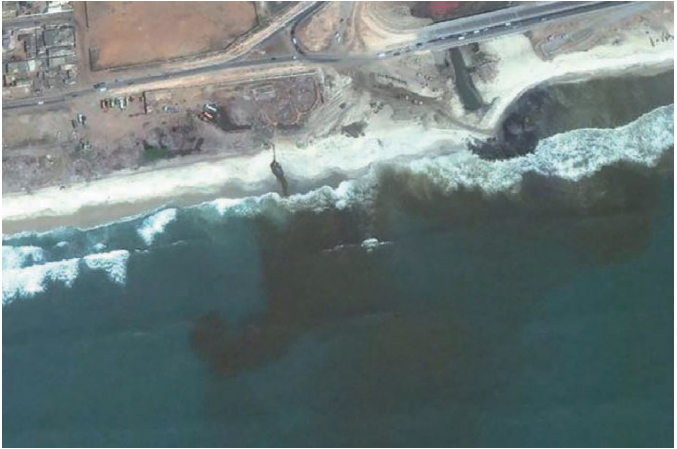
Figura 14.1 El sitio en Accra, Ghana, donde se botan los lodos fecales directamente en el mar (foto: Google Earth, 2010).
