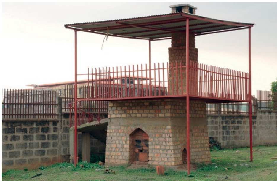
Figura 18.6 Horno en tamaño piloto del proyecto FaME (Emprendimientos para Manejo Fecal) para la co-combustión de lodos fecales en la producción de ladrillos en Kampala, Uganda (foto: Pitman Ian Tushemezibwe)
