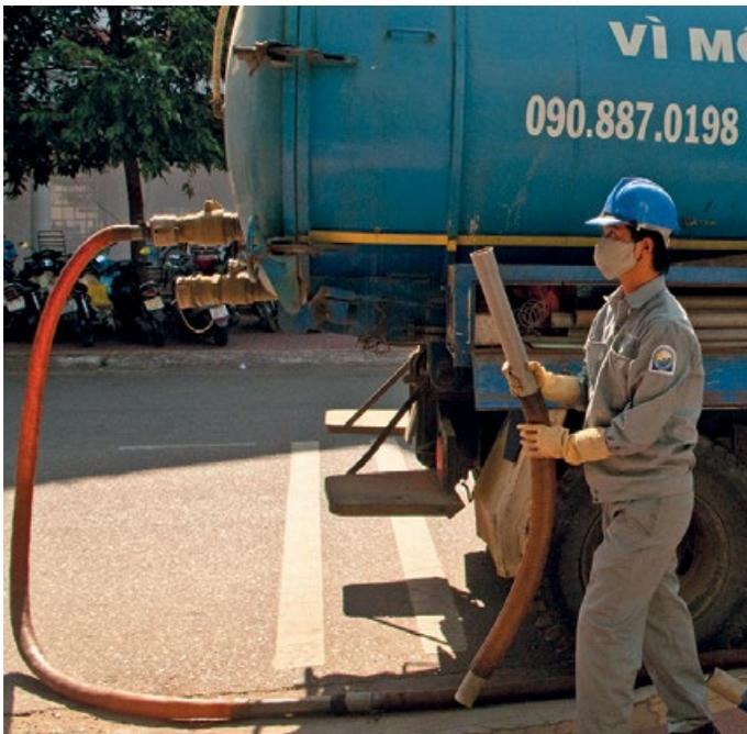
**Figura 4.12** Ejemplo de un buen método para ensamblar la manguera fácil y rápidamente (foto: Linda Strande).
