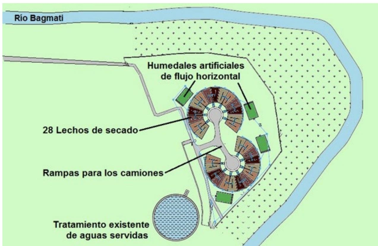
**Figura 7.3** Plano propuesto para una estación de tratamiento de lodos fecales en Nepal. Los 28 lechos de secado estarán ubicados en dos círculos, con puntos centrales para la descarga de los camiones. Los lixiviados serán tratados en humedales con flujo subterráneo horizontal (HPCIDBC, 2011).
