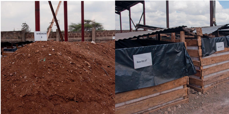
Figure 10.3 : Cocompost de boues de vidange et de déchets organiques municipaux réalisé par Sanergy à Nairobi, Kenya (photo : Linda Strande).
