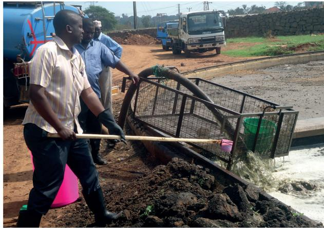
Figure 2.5 : Dégrillage de déchets solides de boues de vidange à l'entrée d'une station de traitement lors d'une campagne de prélèvement à Kampala, Ouganda (photo : Daniel Ddiba).
