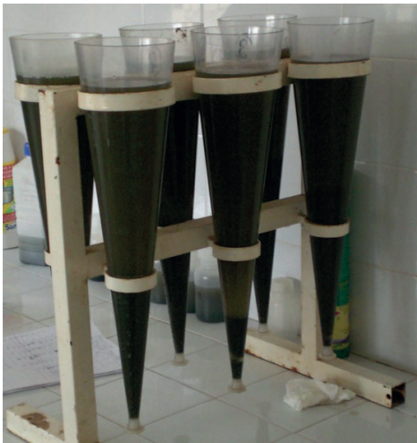
Figure 6.4 : Cônes Imhoff utilisés pour mesurer l'indice de boue (photo : Sandec).
