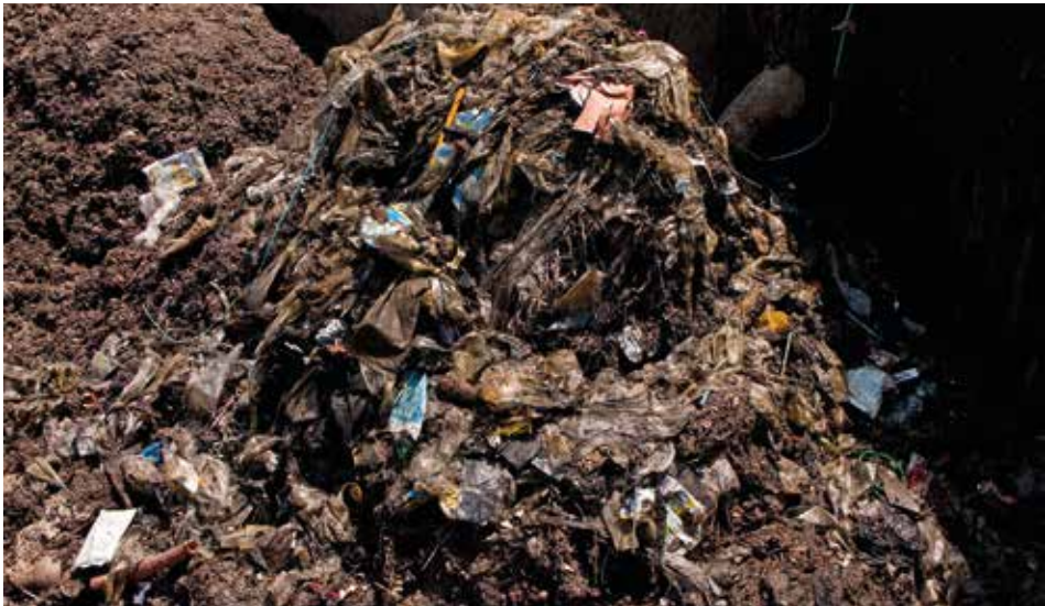
Figure 10.13 : Refus de dégrillage de la station de traitement des boues de vidange de Niayes à Dakar, Sénégal (photo : Linda Strande).
