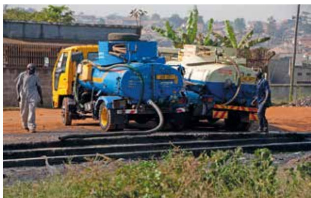
Figure 12.6 : Camions de vidange privés dépotant des boues de vidange dans une station appartenant à une municipalité, Kampala, Ouganda (photo : Linda Strande).
