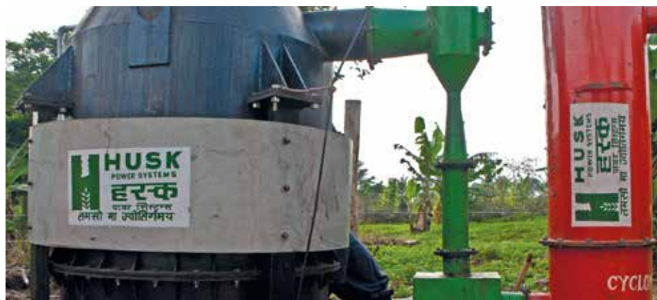
Figure 10.12 : Projet de gazéification Liribogo à partir de feuilles de maïs et de sciure, situé dans le sous-comté de Muduma, district de Mpigi, Ouganda (photo : Linda Strande).
