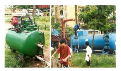
Figure 14: Petite cuve à boues reliée à une pompe manuelle d'aspiration à Mapet, Congo
