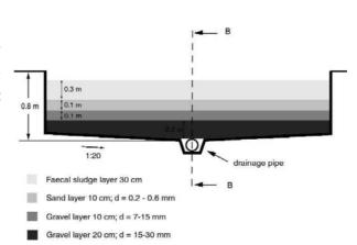
chargées sur le lit et l'eau qu'elles contiennent s'évacue dans sa majorité par percolation à travers le filtre, le reste par évaporation. Les boues ainsi déshydratées peuvent être soit directement mises en décharge soit soumises à un traitement d'hygiénisation si une valorisation agricole est envisagée. La qualité des percolats est améliorée par la filtration mais un polissage peut être encore nécessaire.
