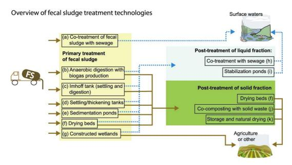
Figure 15: Vue d'ensemble des techniques de traitement à faible coût des BV et de leurs combinaisons possibles
