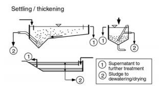
manuellement ou au moyen de chargeurs frontaux après évacuation de la colonne de liquide et respect d'une période de séchage. Les boues sédimentées nécessitent généralement un traitement ultérieur.
