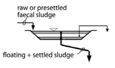
Quand utiliser ce système? Les étangs de sédimentation/stabilisation peuvent servir au traitement primaire des BV lorsque la station dispose de suffisamment d'espace. Ce type de dispositif convient aux BV fraîches et constitue souvent la première cellule d'un système de lagunage composé d'une série de bassins de stabilisation.
