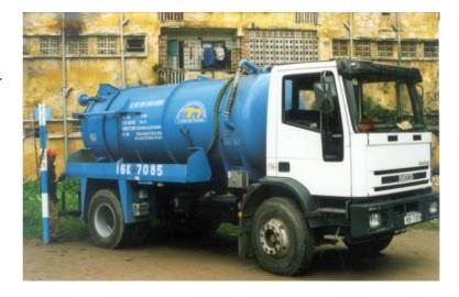
Figure 13: Miniremorque de vidange par aspiration (350 I) utilisée pour les ruelles étroites et citerne de stockage transitoire placée dans l'artère accessible la plus proche à Hai Phong, Vietnam
