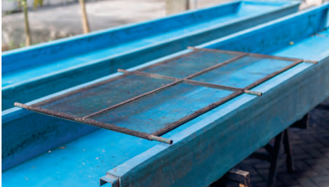
1. Penyaring untuk tempat dituangkannya larvero . 2. Alat untuk meratakan material dan memisahkan larva dari air
