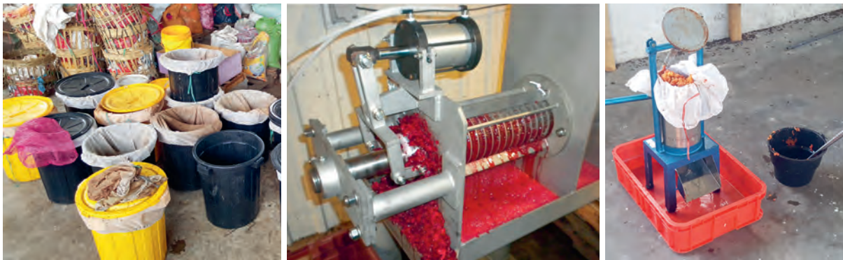
Gambar 20: Perbedaan metode pengurangan kadar air pada sampah: pengeringan pasif dengan gravitasi (kiri), screw press (tengah), cider press (kanan), (Foto screw press: Vincent Corporation)
