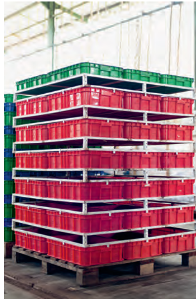
Tumpukan larvero. Bingkai besi membantu penguapan air dari sampah (T1-2)
