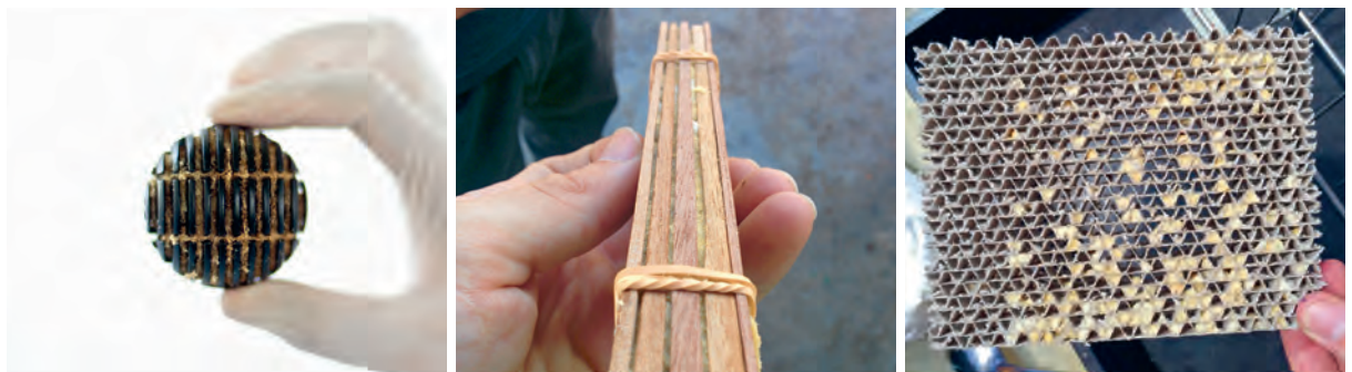
Gambar 8: Berbagai variasi eggies: "Bioballs", biasanya digunakan sebagai filter di akuarium dan kolam (kiri), tumpukan lembaran kayu dengan celah-celah kecil di sela-selanya (tengah), dan bentuk sarang lebah dari kardus (kanan).
