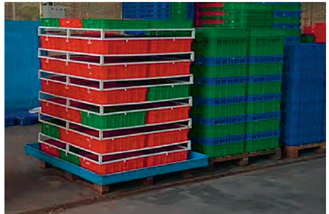
Gambar 16: Susunan larvero dengan bingkai ventilasi di celah-celahnya setiap lapisan.
