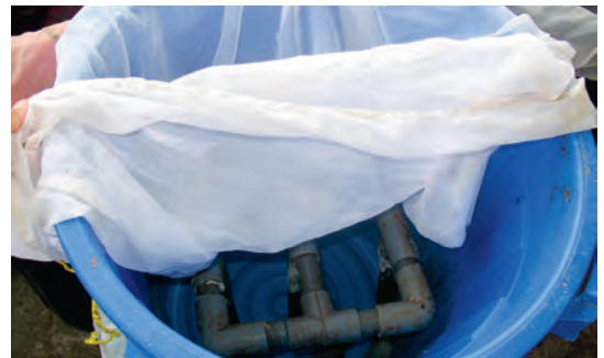
Bingkai plastik di dalam ember menjaga kain dan sampah tetap kering ( W2-1 )
