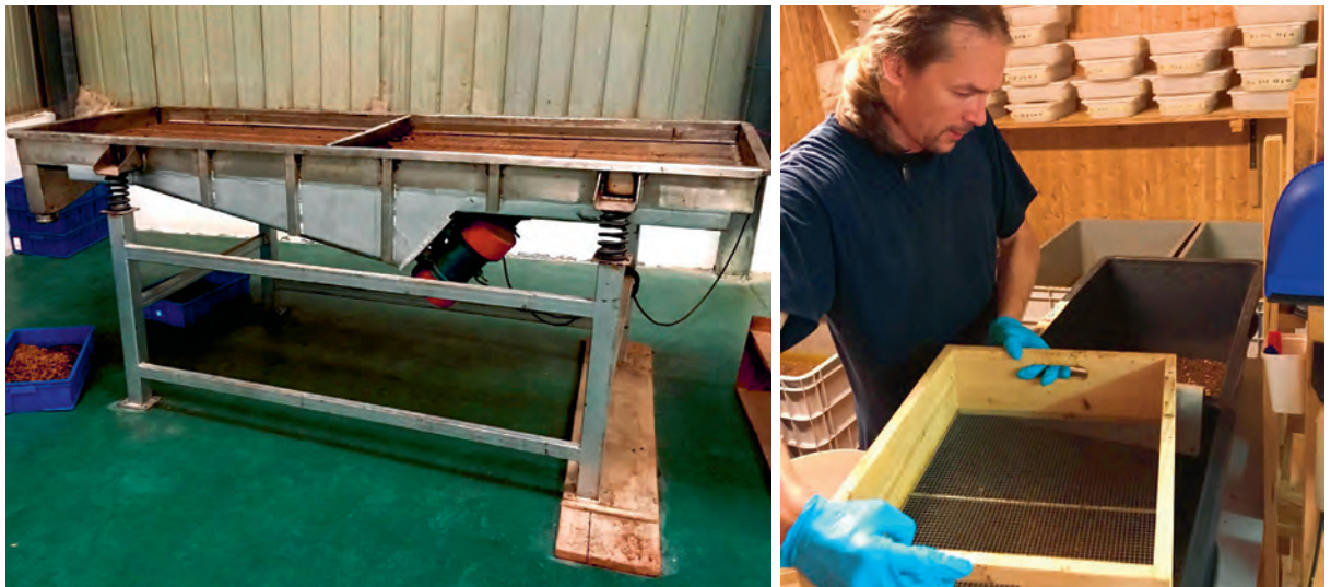
Gambar 17: Shaking sieve (kiri) dan sieve manual (kanan) untuk memisahkan larva dari residu.
