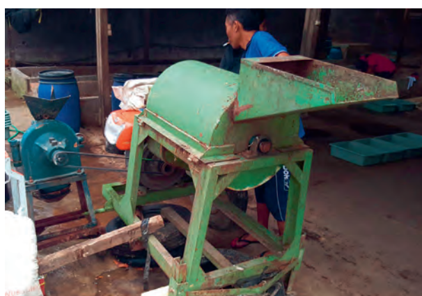
Gambar 15: Hammer mill atau palu pabrik untuk pra-pengolahan sampah
