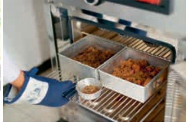
Sampel untuk berat kering yang diletakkan di oven.
