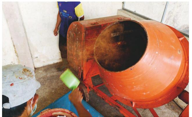
**Étape 6 + 7** : Conditionnement du substrat par ajout de matière sèche si la teneur en eau est trop élevée et par ajout d'eau si la teneur en eau est trop faible.
