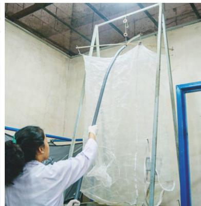
**Étape 2 :** Utilisation du bâton de déplacement de la cage pour accrocher la cage d'amour au cadre mobile.
