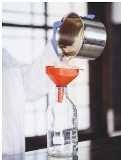
**Étape d'adaptation 1** : Installation simple à l'aide d'un filtre à café et d'un entonnoir.
