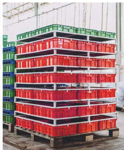
Figure 4-6 : Superposition des bacs à larves avec des cadres de ventilation entre les niveaux.
