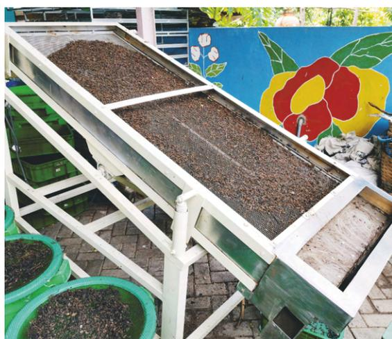
Figure 4-7 : Tamis à secousses pour séparer les larves des résidus secs.
