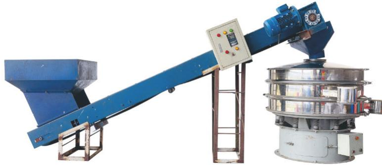
**Convoyeur** (fabriqué sur mesure) et **système de séparation** (Guan-Yu, GY-1000-2S). Tamis de dimensions 100 x 106 cm, dynamo 2HP avec tension de 380 (triphase) et 1440 rpm.
