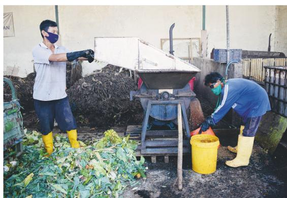
Figure 4-1 : Broyeur à marteaux pour le prétraitement des déchets.
