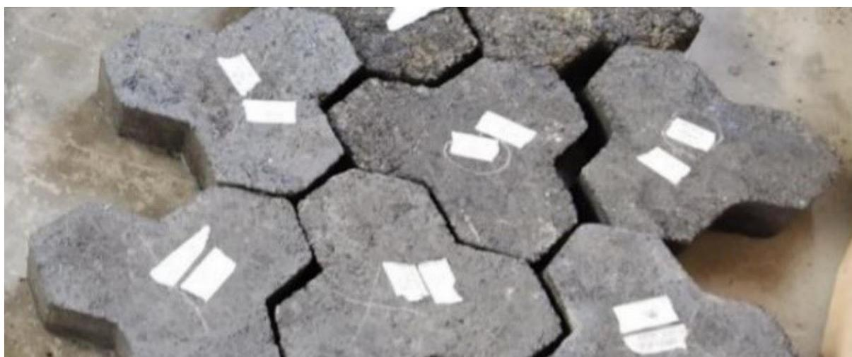
**El proceso de fabricación de adoquines es un método de reciclaje que consiste en triturar plástico, fundirlo, mezclarlo con arena y, finalmente, verterlo en moldes para adoquines antes de enfriarlo.**
