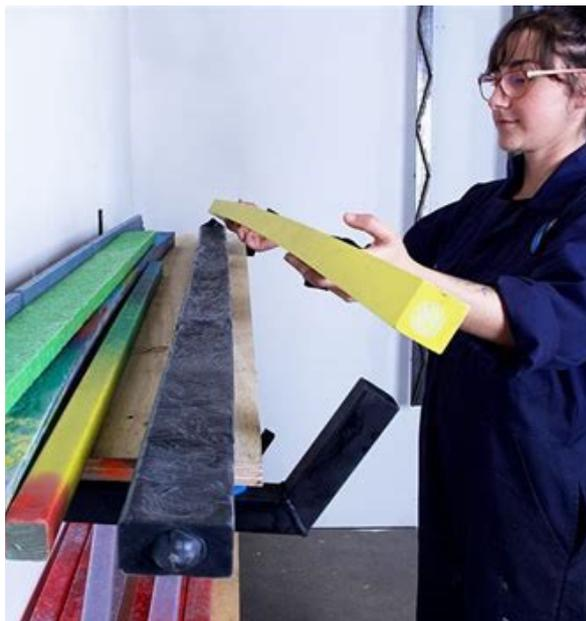
L'extrusion du plastique est une technologie de recyclage qui convertit les déchets plastiques en un filament plastique continu, qui peut ensuite être moulé dans n'importe quelle forme de produit final souhaitée.
