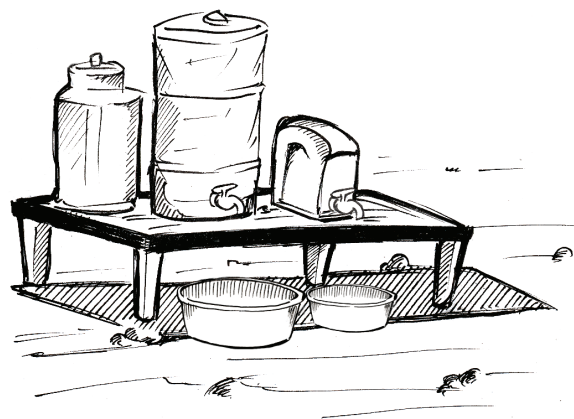
Station lavage des mains avec contenants fermés et bassines
