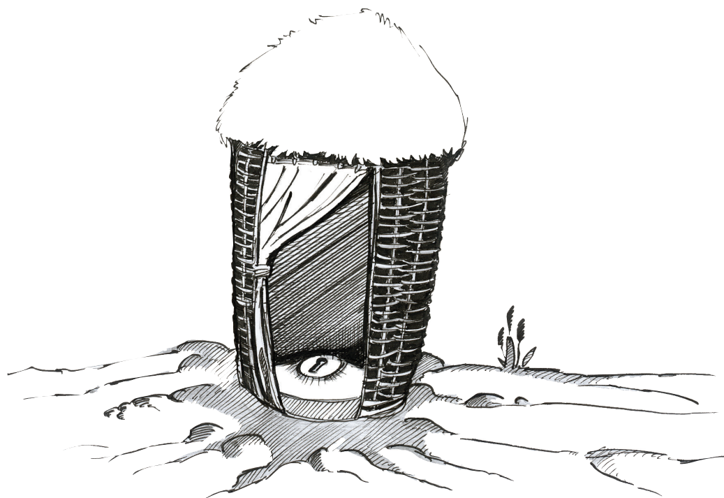
Latrines à fosse unique
