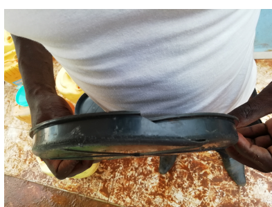
(a) Broken lid
