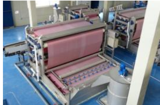
Ilustraciones 15 y 16: Estanque de espesamiento y filtros de banda en la planta de tratamiento de lodos de ETAPA
