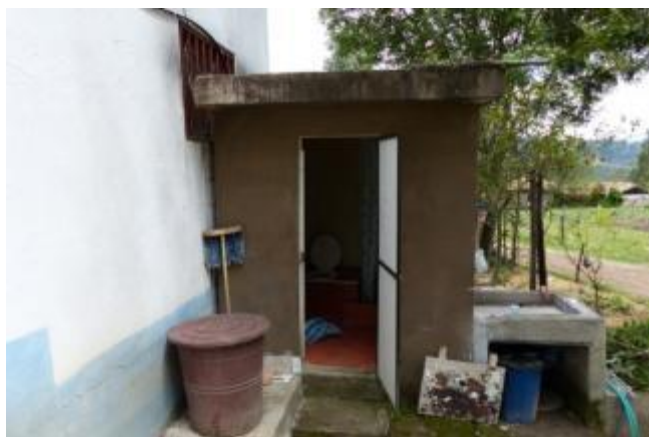
Ilustraciones 6 y 7: Retrete seco en La Libertad con tanque de almacenamiento de los lodos
