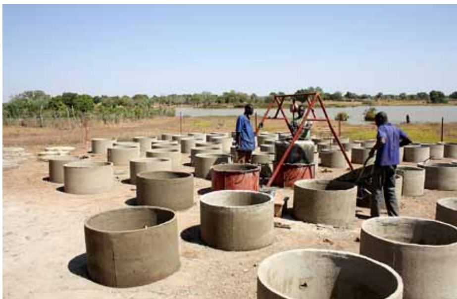
Site de production en série de buses pour les fosses des latrines à Fara (Burkina Faso).
