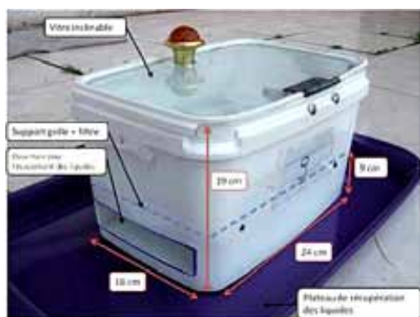
Mini-four solaire (vue extérieure).
