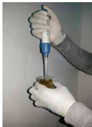
Une étape de l'analyse de la DCO par spectrophotométrie.
