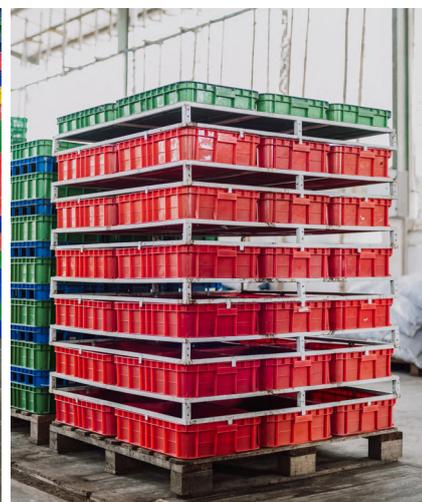
Gambar 4-6: Tumpukan larvero dengan kerangka ventilasi diantara tumpukan boks
