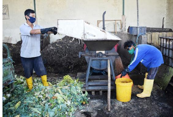
Gambar 4-1: Mesin pencacah (hammer mill) untuk pra-pengolahan
