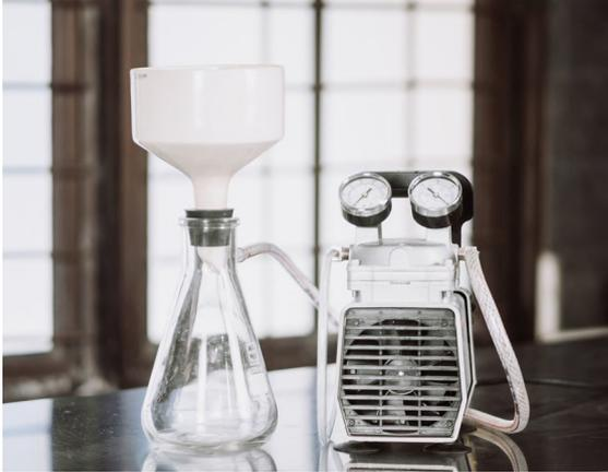
Set-up mesin pompa vakum. (Langkah 1)
