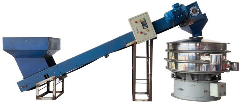
**Konveyor** (dibuat secara khusus) dan **sistem penyaringan** (Guan-Yu, GY-1000-2S). Saringan dengan dimensi 100x100x106 cm, 2HP dinamo dengan voltase 380 (3-phase) dan 1440 rpm
