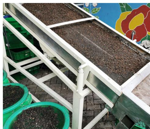
Gambar 4-7: Mesin ayak untuk memisahkan larva dari residu kering
