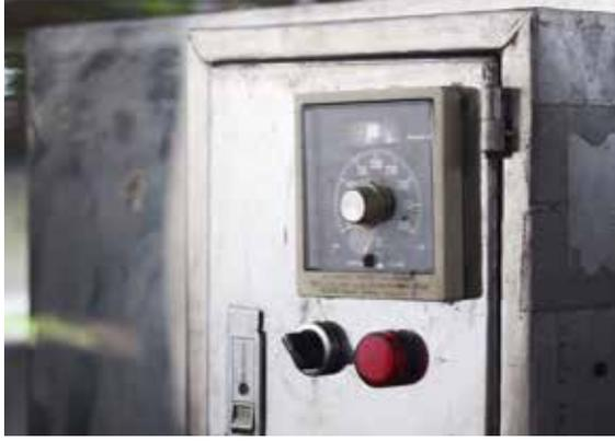
**Langkah 1:** Mengatur thermostat pada suhu 65°C.
