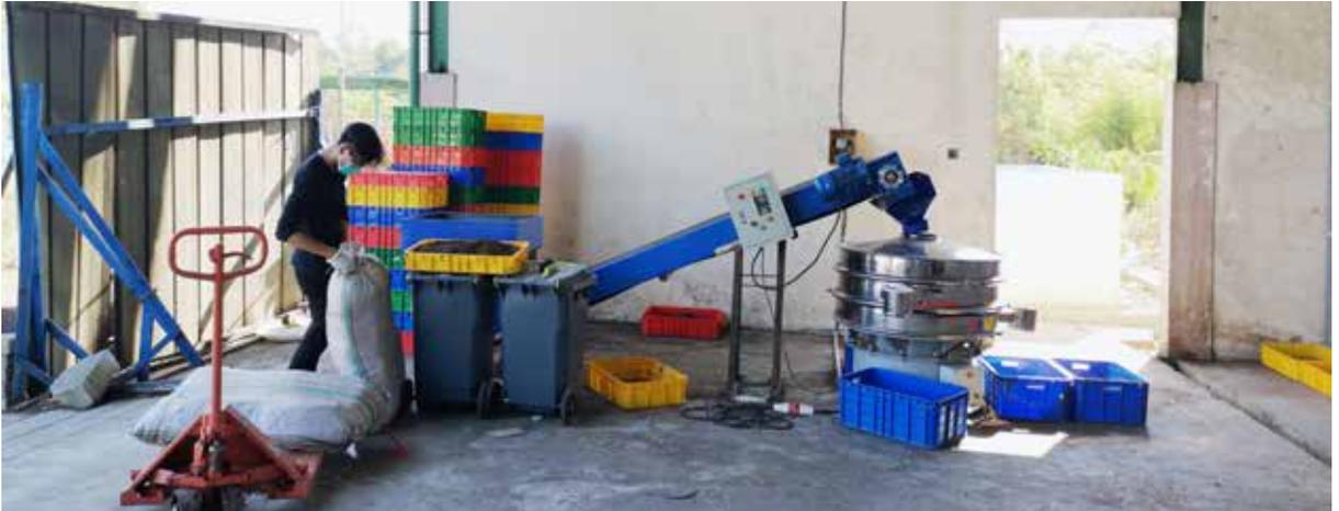
Area pemanenan dengan mesin penyaringan, boks untuk menampung fraksi yang keluar dari mesin ayak, dan karung berisi residu
