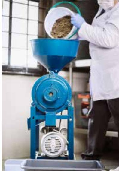
Memasukkan press cake ke mesin giling. (Langkah 2)
