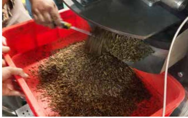
**Langkah 3:** Mengosongkan drum melalui pintu penutup depan.
