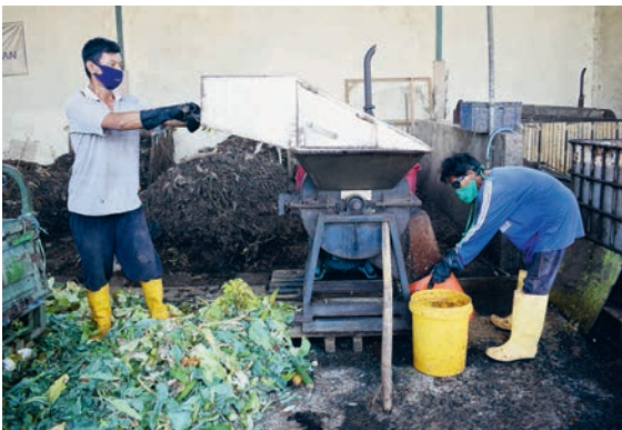
ပုံ(၄-၁) စွန့်ပစ်ပစ္စည်းများကို ဖြတ်တောက်ချေမှုခြင်း ကနဦးလုပ်ငန်းစဉ်အတွက် အသုံးပြုသည့် မောင်းတံပါရှိသည့် ထုချေစက်
