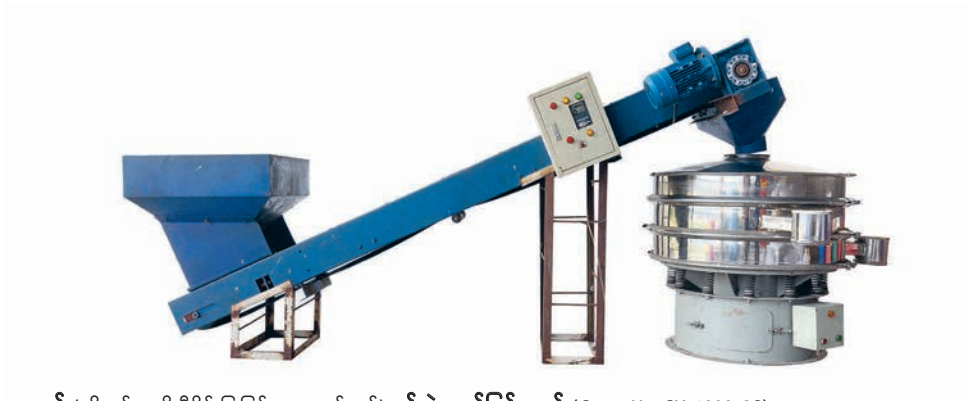
ရွှေလျားစက် (လိုအပ်သလို ဒီဇိုင်းပြုပြင်ထားသည့်စက်) နှင့် ခွဲထုတ်ခြင်းစနစ် (Guan-Yu, GY-1000-2S)။ ဆန်ကာအတိုင်းအတာ (၁၀၀ x ၁၀၀ x ၁၀၆ စင်တီမီတာ၊ ဗို့အား (၃၈၀) ပါဝါလိုင်း(၃)လိုင်းဖြင့် တစ်မိနစ်လျှင် ပတ်ရေ (၁၄၄၀) လည်ပတ်သော မြင်းကောင်ရေနှစ်ကောင်အား ခိုင်နမ့်မှုကို အသုံးပြုထားသည့် စကာတိုက်စက်။
