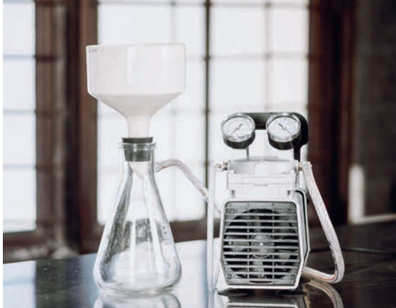
အဆင့်(၁) လေစုတ်ကိရိယာကို အသုံးပြုရန် ဆင်ထားပုံ။
