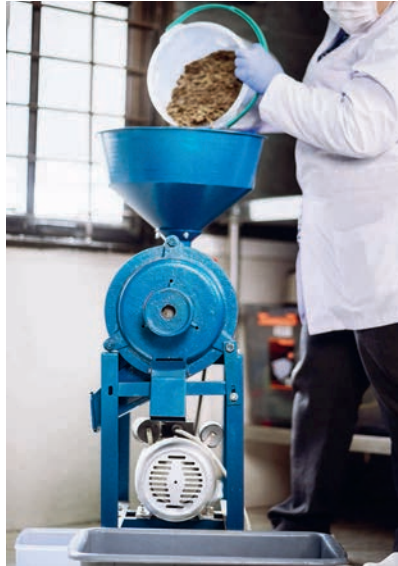
အဆင့်(၂) သားလောင်းခြောက်အစိုင်အခဲကို ကြိတ်ခွဲစက်အတွင်းသို့ထည့်ခြင်း။
