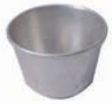
အခြောက်ခြစ်ပါဝင်မှုကို ခွဲခြမ်းလေ့လာရာ၌ အသုံးပြု သည့်ခွက်
