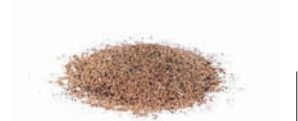
သန့်စင်သည့် ကမ်းခြေသဲ သဲမှုန်အရွယ်အစား ၀.၈ မှ ၁.၅ မီလီမီတာ
