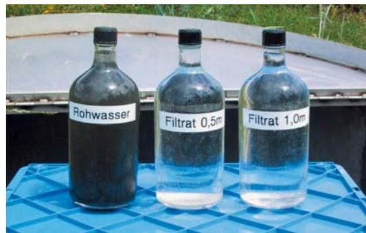
Abb. 6 Der Boden ist zwar ein effizienter Filter, wie dieser Vergleich von verschmutztem Strassenabwasser mit dem Sickerwasser am gleichen Ort in 0,5 und 1 Meter Tiefe zeigt. Trotzdem werden nicht alle Schadstoffe zurückgehalten. (Quelle: GSA Bern)
