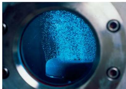
Abb. 4 Die Begasung des Wassers mit Ozon inaktiviert Krankheitserreger wie Bakterien und Viren. (Quelle: Wasserversorgung Zürich)
