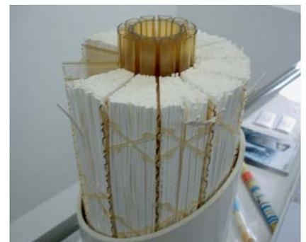
Abb. 9 Innenleben eines Membranfilters. Im Bereich der Ultrafiltration beträgt die Porengrösse nur gerade 2 bis 50 Milliardstel Meter. (Quelle: WWA Bern)
