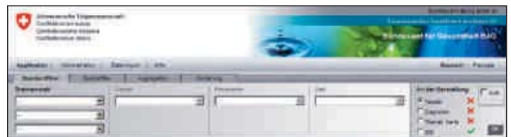
Abb. 3 Einstieg in die Auswerteapplikation der Trinkwasserdatenbank mit vier Registerkarten zur Definition der Abfrage und der Auswahl der Darstellungsmöglichkeiten der ausgewählten Informationen. Um eine Abfrage zu formulieren, muss immer zuerst mit der dreistufigen Themenwahl ganz links auf der Registerkarte Standardfilter begonnen werden.
