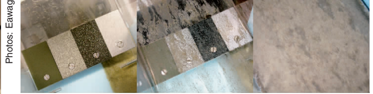
图3 不同表面特性的钢试件上的生物膜形成 废水槽中曝露0天(左)、2天(中)7天(右)之后
