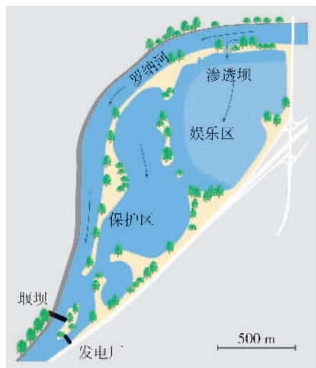
图4 罗纳河上一个多目标水管理设施的总设计和要素
