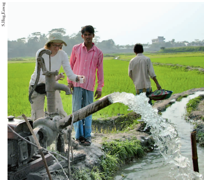
数据收集:在孟加拉国,对用于灌溉稻田的地下水中的砷浓度进行检测
