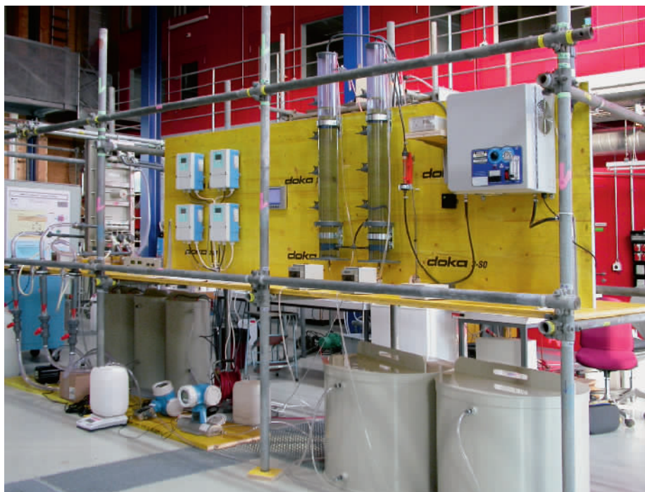
用尿生产液体肥料的试验装置所用的尿来自利斯塔尔的巴塞尔兰州图书馆——一座全部安装非混合抽水马桶的新大楼
