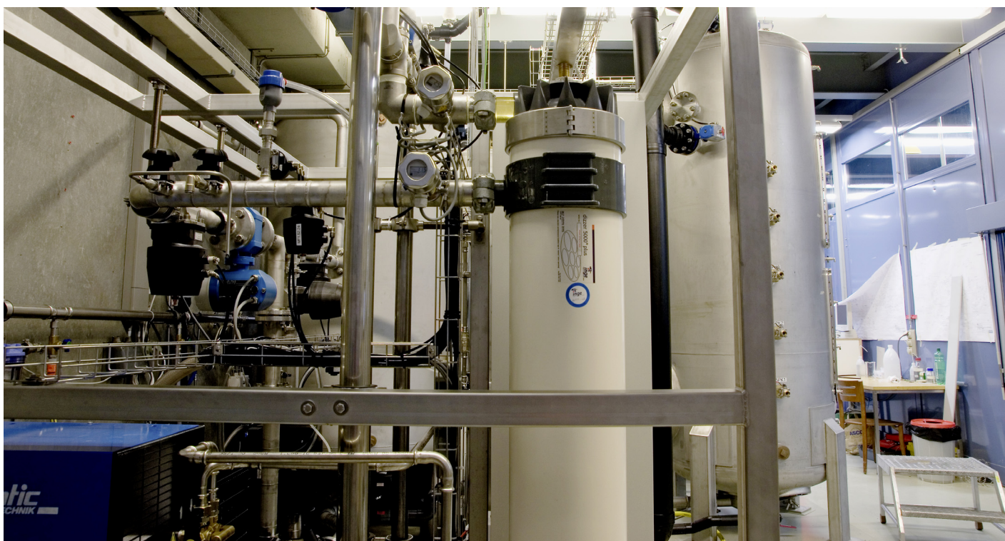
Lengg湖水处理厂测试的试验装置中的膜组件
