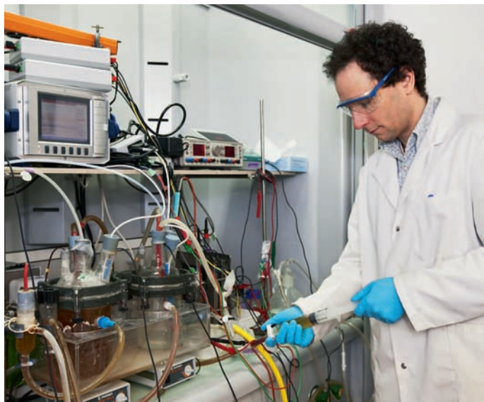
在实验室中，过程工程师Kai Udert正在检验各种用于从尿中去除养分和污染物的反应器
