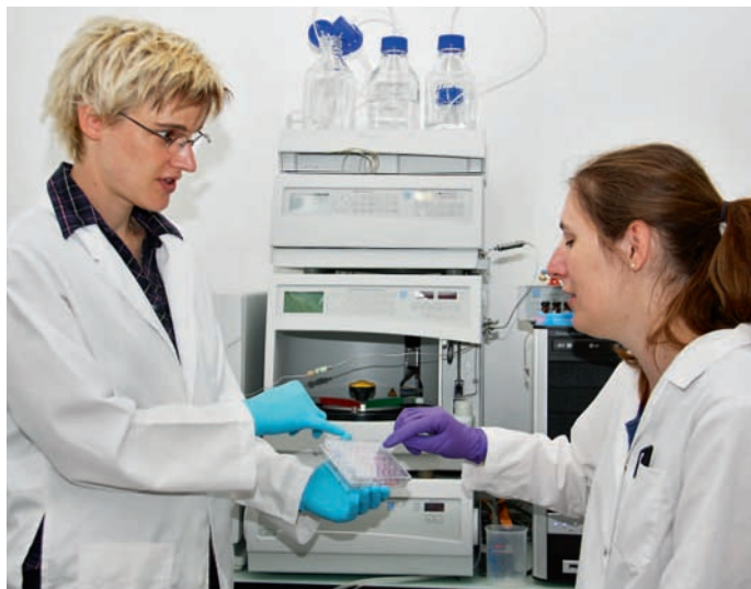
Nadine Bramaz与Hana Meslankova讨论微量滴定板中母化合物与转化产物混合物的毒性结果。背景是用于确定该混合物中母化合物浓度的光谱系统
