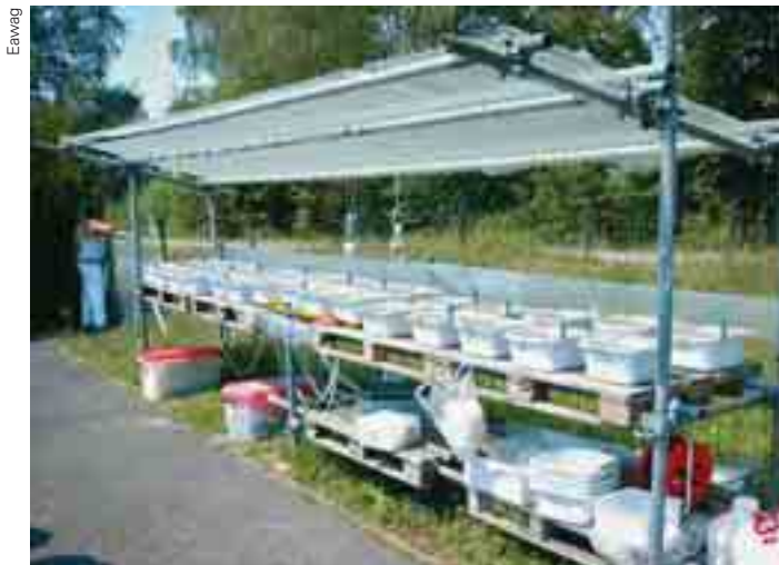
Abb. 1: Mikrokosmosanlage, in der natürliche Algenbiofilme herangezüchtet und an erhöhte Metallkonzentrationen exponiert werden.
