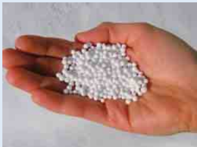
Styroporkügelchen und Kunststoffteilchen als Trägermaterialien im Fest- und Wirbelbett.
