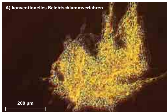
Abb. 1: Belebtschlammflocken aus der konventionellen Belebtschlammanlage mit Nachklärbecken (A) und aus dem Membranbioreaktor (B) unter dem Phasenkontrast-Mikroskop.
