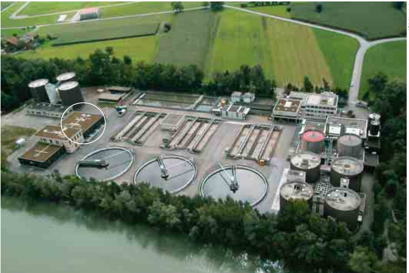
Flugbild der ARA Altenrhein: das Biofiltergebäude (im Kreis) beansprucht 8-mal weniger Fläche als die konventionelle Anlage mit 3 rechteckigen Belebtschlamm- und 3 runden Nachklärbecken; dennoch behandeln beide Anlagen je die Hälfte des zulaufenden Abwassers.
