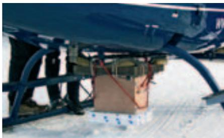
La caméra infra-rouge a été montée sous le plancher de l'hélicoptère.
