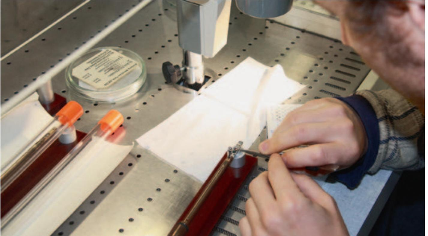
Die zu untersuchende Probe wird auf dem Halter platziert.
