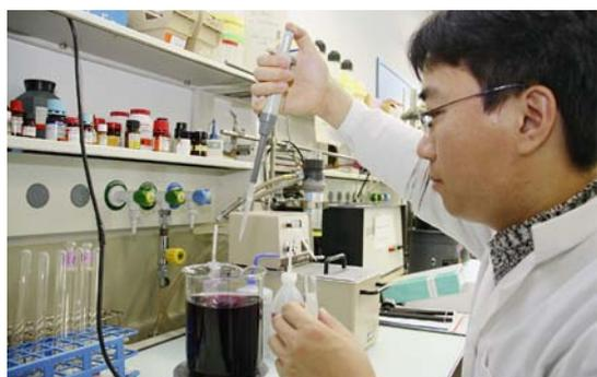
Post-doctorant Yunho Lee détermine la concentration en Fe(VI) d'une solution d'essai.
